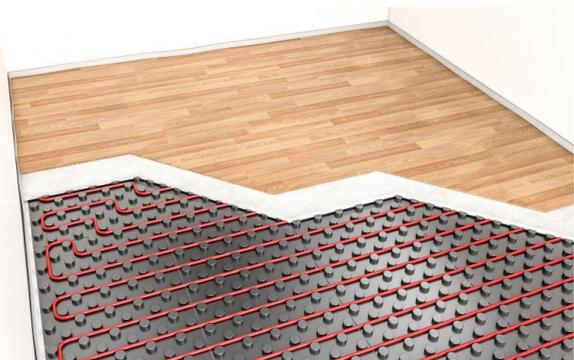
El suelo radiante/refrescante consiste en una red de tuberías instalada por el suelo sobre una placa aislante, por la que circula agua caliente o fría según la época del año. La temperatura se difunde de forma homogénea por toda la vivienda. El suelo refrescante permite reducir la temperatura interior de la vivienda en los meses de verano.
